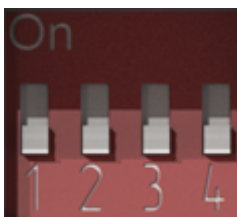
Рис. 6.6. DIP-переключатель. Джампер 2 в положении OFF
