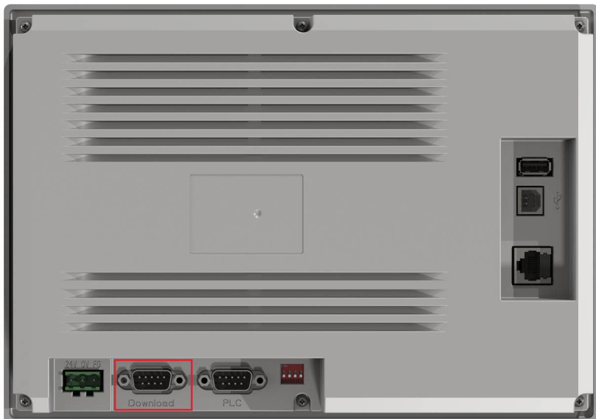
Рис. 6.7. Внешний вид задней крышки панели СП3xx-P ( Download-порт обведен красным)
