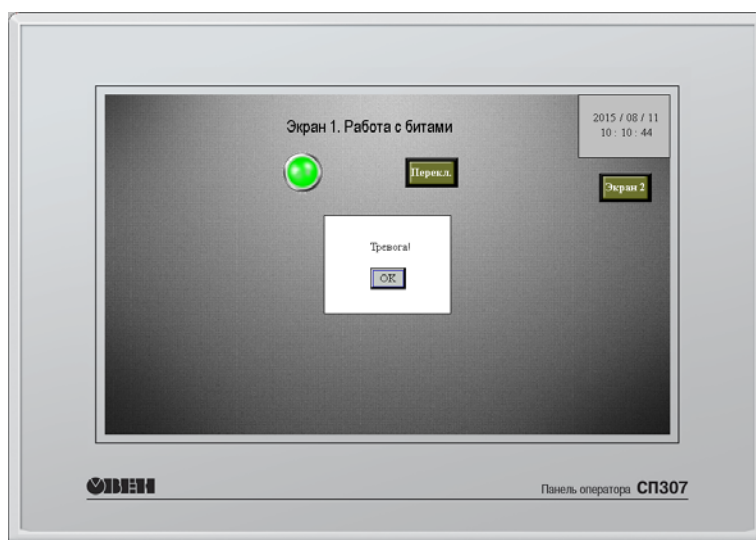
Рис. 3.39. Режим эмуляции проекта в конфигураторе СП300
