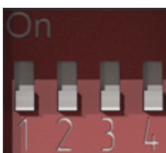
Рис. 6.13. DIP-переключатель. Джампер 2 в положении OFF
